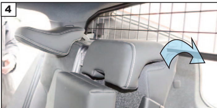
4 Check Guard is centred. Firmly Close Seats back. Stellen Sie sicher, dass Gitter zentriert ist. Sitze schließen
