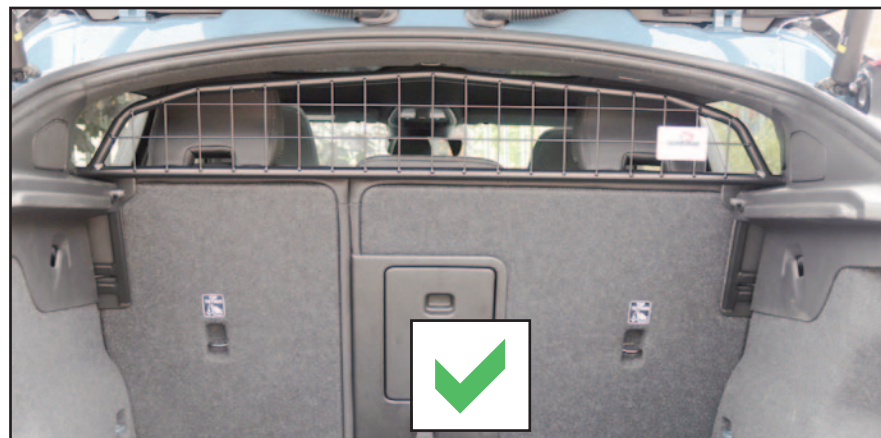
2 Insert Guard - Badge to the back of car Teil einfügen - Plakette zum Fahrzeugeck hin
