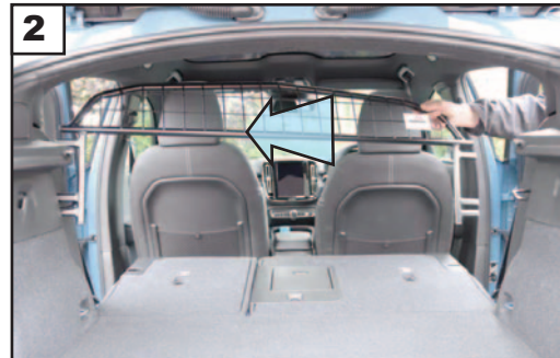
2 Insert Guard - Badge to the back of car Teil einfügen - Plakette zum Fahrzeugeck hin
