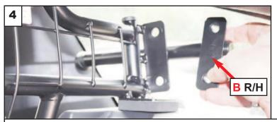
Insert R/H side arm. Manually adjust the plastic tilitserts at the end of the side arms if necessary. Setzen Sie den R/H-Seitenarm ein. Passen Sie bei Bedarf die Kunststoff-Tilitserts am Ende der Seitenarme manuell an
