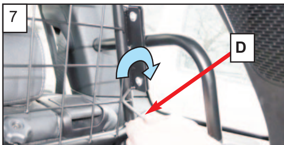
7 Tighten bolts. Repeat for R/H side Schrauben festziehen. Wiederholen Sie dies für die R/H Seite
