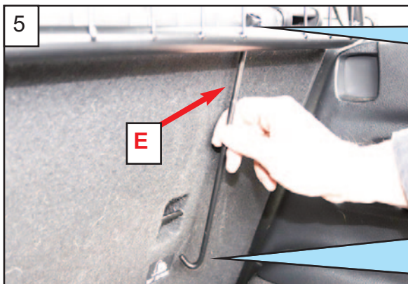
3 Insert R/H side arm. Setzen Sie den R / H-Seitenarm ein.
