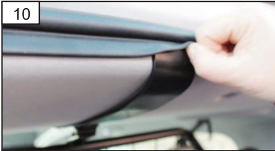
10 Fold the rubber seal over the bracket Falten Sie die Gummidichtung über die Halterung
