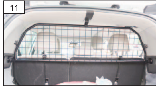
11 Check tightness of all fixings Überprüfen Sie den festen Sitz aller Befestigungen
